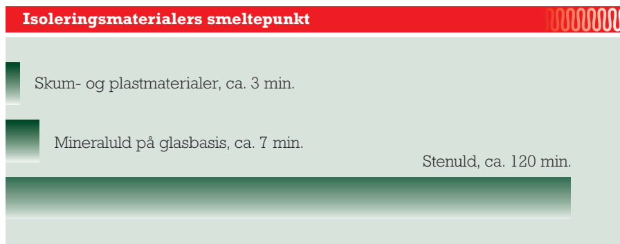
Figur 2: Søjlerne angiver, hvor lang tid det varer inden forskellige isoleringsmaterialers smeltepunkt nås, når materialerne brandpåvirkes svarende til standardbrandkurven.
