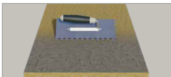
Fase 8: Disposizione di uno strato di malta adesiva sull'intera superficie del pannello.
