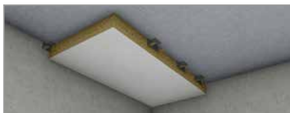
Fase 7: Posa del pannello con la successiva fila di fissaggi.
