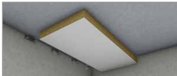
Fase 6: Inserimento del pannello nella prima fila di fissaggi.
