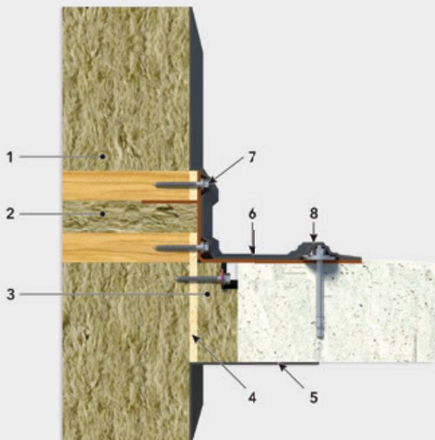
1. Laine de roche de 190 mm d'épaisseur (densité minimale :  $45 \text{ kg/m}^3$ )
