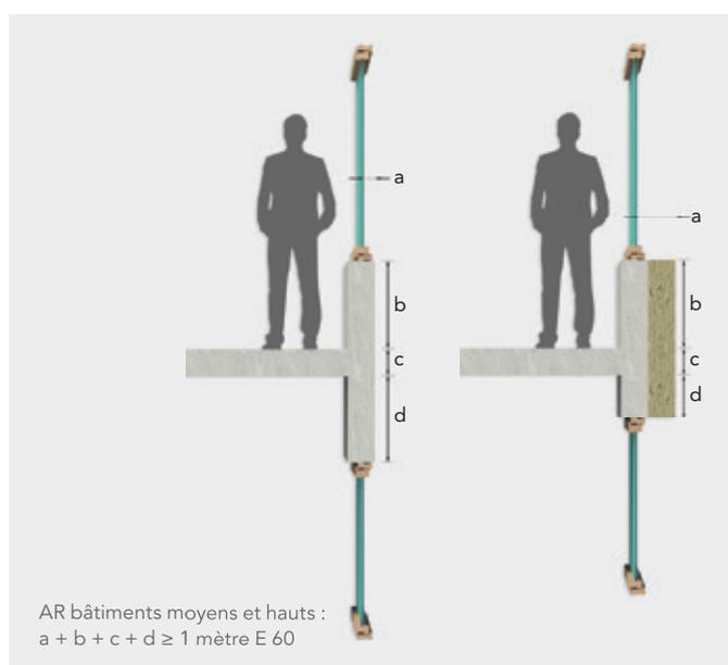
La laine de roche ROCKWOOL est incombustible et peut résister à des températures supérieures à 1 000 °C. Grâce à ces propriétés, lors de l'utilisation de l'isolation de façade ROCKWOOL, l'épaisseur de l'isolation peut être incluse dans le calcul de la longueur d'un mètre.
