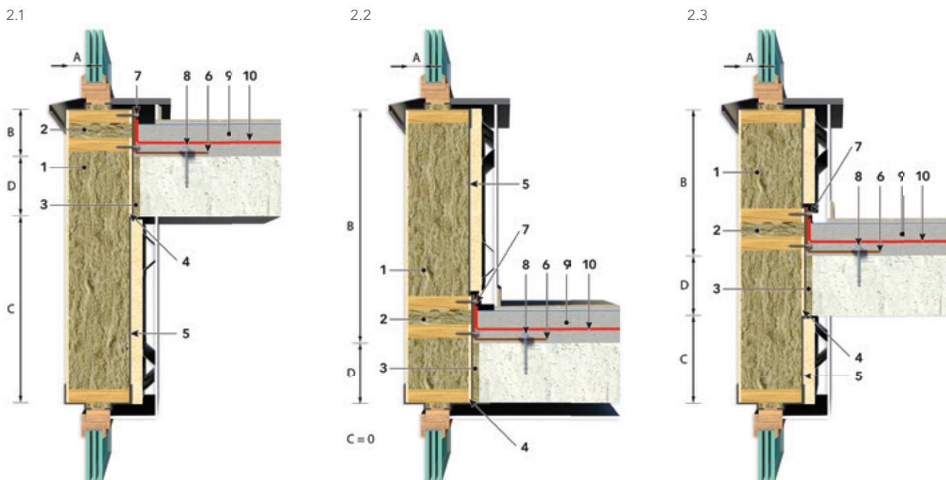
1. Laine de roche de 190 mm d'épaisseur (densité minimale : 45 kg/m<sup>3</sup>)
