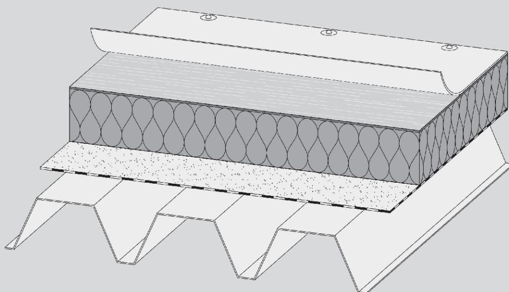
Druckbelastbare Steinwolle-Dachdämmplatte\* mit spezieller lastverteilernder, faserverstärkter Beschichtung. Die Beschichtung erhöht in besonderem Maße die Widerstandsfähigkeit gegenüber Punktlasten, z. B. bei mechanischen Beanspruchungen durch häufigeres Begehen, bei Terrassenbelägen mit Stelzlagern oder bei Dachbegrünungen.
