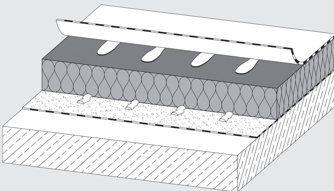
Hoch verdichtete, druckbelastbare Steinwolle-Dachdämmplatte mit oberseitiger Mineralvlieskaschierung
