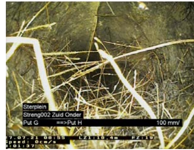
Figuur 10: Voorbeeld van wortels die het kanaal in groeien
