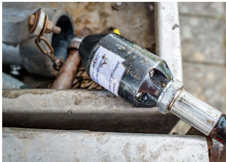
Figuur 12: 0-15° of terugspoeiende sproeikop
