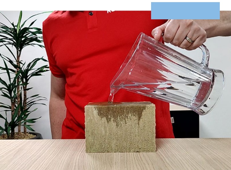
Rockflow-steenwol kan bijna zijn volledige volume aan water opnemen
