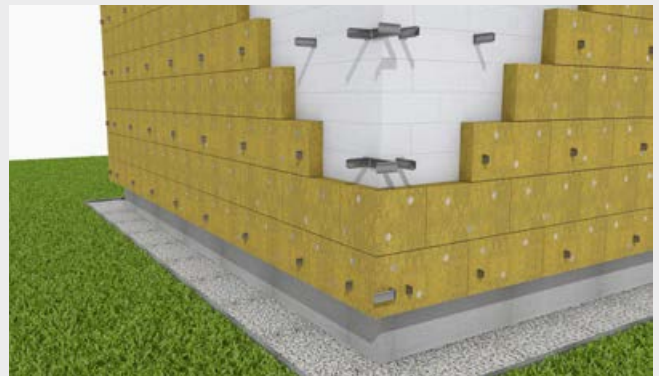
Ułożenie i zakółkowanie wełny do ściany.
