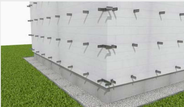
Montaż konsoli do ściany.
