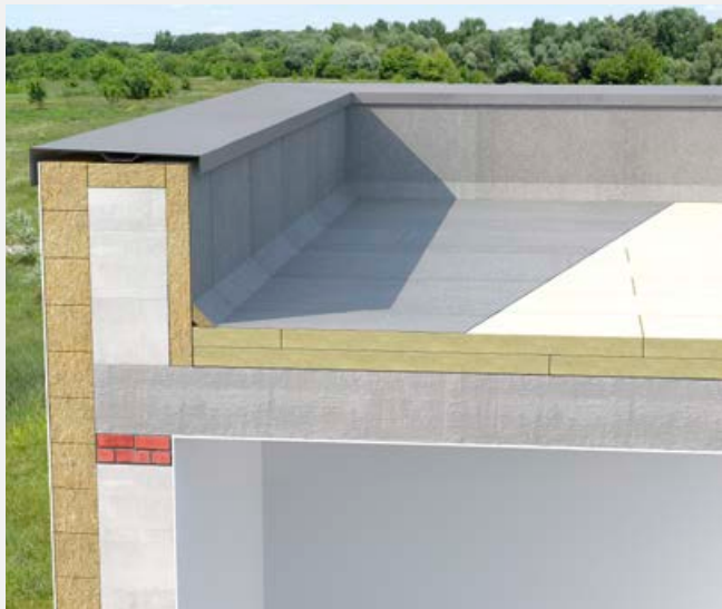
Papa podkładowa samoprzylepna lub podkładowa przygrzana do HARDROCK MF PLUS.
