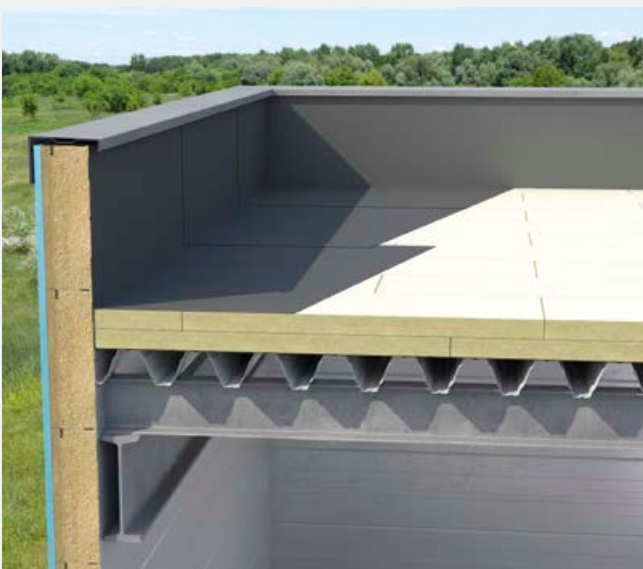
Przyklejenie membrany i zespolenie jej na zakładzie
