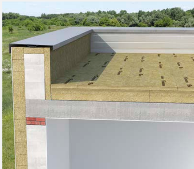
Układanie płyt zasadniczego ocieplenia na sucho.
