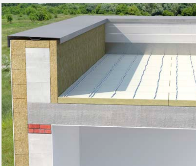
Przyklejenie pierwszej warstwy HARDROCK MF PLUS klejem.
