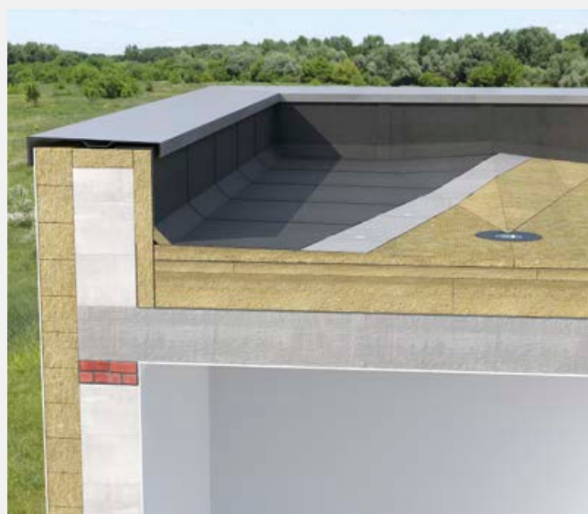
Zgrzewanie papy nawierzchniowej do papy podkładowej.
