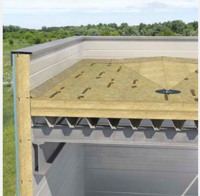
Układanie płyt kontrspadkowych ROCKFALL (KSP).
