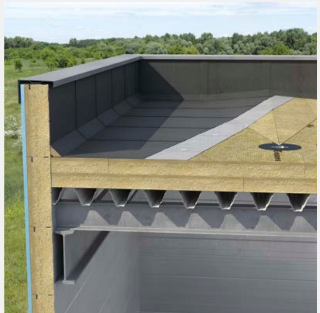
Zgrzewanie papy wierzchniej do papy podkładowej.
