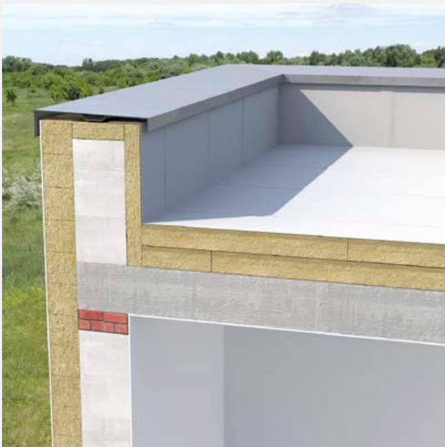
Membrana PVC zgrzewana na zakładkę.
