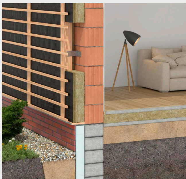
Zamocowanie łąt pod łupkę elewacyjną.
