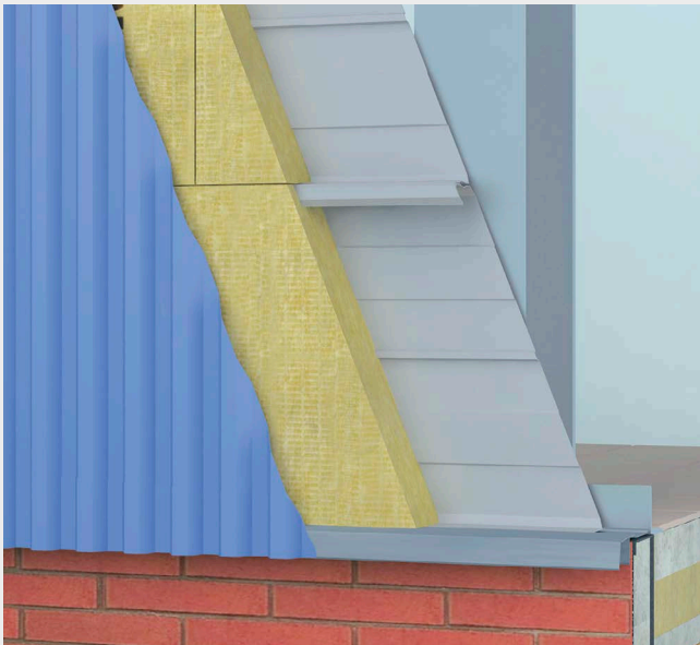
Przykręcanie blachy elewacyjnej.
