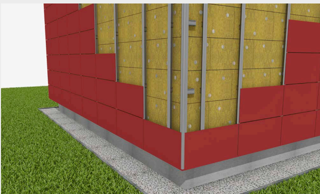
Zamocowanie płyt elewacyjnych.
