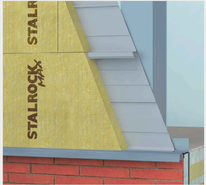
Ułożenie wełny STALROCK MAX na mijkę.
