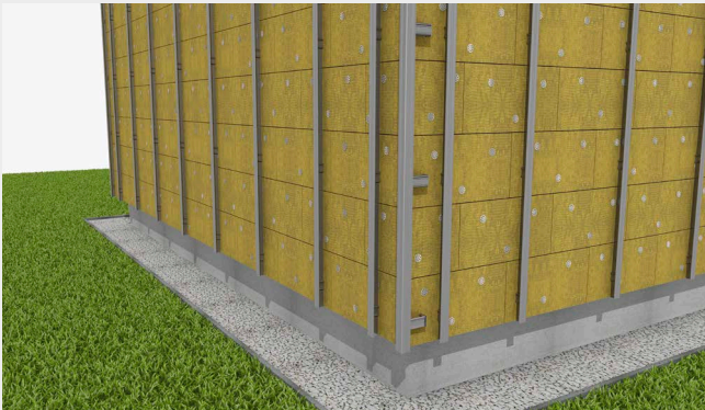
Mocowanie profili podkonstrukcji do konsol.
