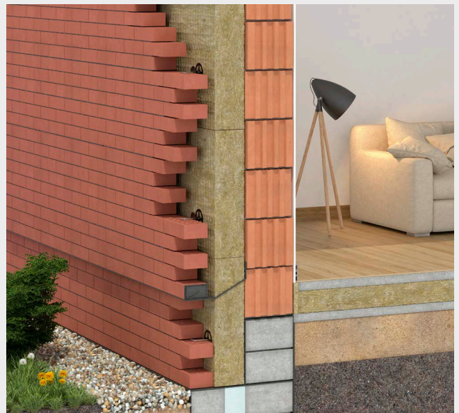
Wymurowanie warstwy osłonowej z klinkieru.
