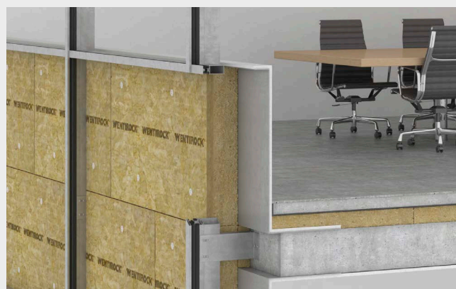
Montaż profili podkonstrukcji do konsol.
