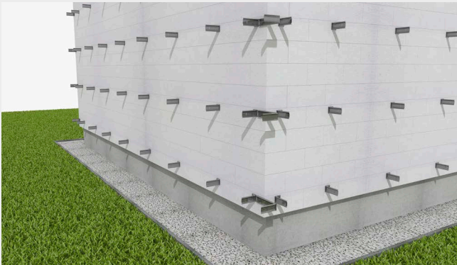
Montaż konsoli do ściany.
