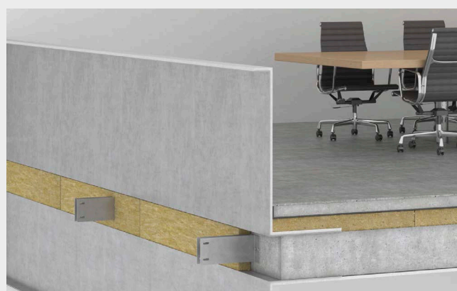
Uszczelnienie wełną na grubości stropu.
