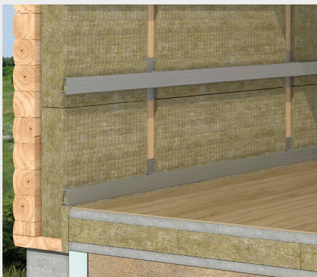
Mocowanie rusztu do słupków.
