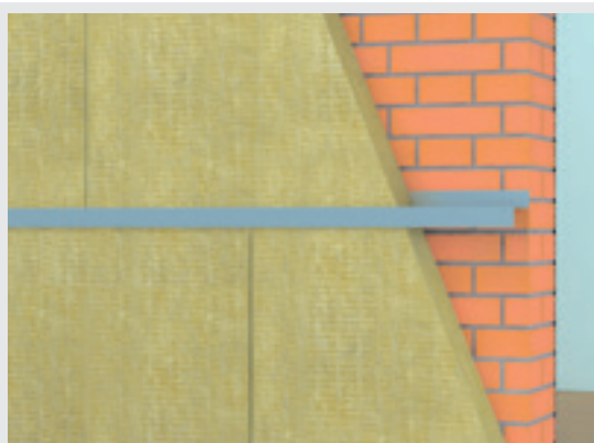
Akmens vatos plokštės VENTIROCK SUPER / VENTIROCK PLUS montuojamos tarp horizontalių plieninių termo profilių.
