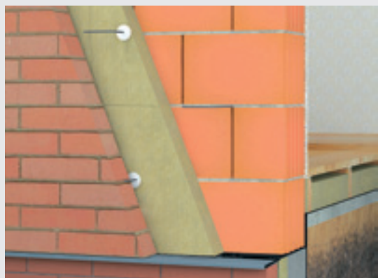
Akmens vatos plokštės VENTIROCK / VENTIROCK F trisluoksnėse vėdinamose sienose montuojamos tvirtinant plieniniais arba stikloplastico ryšiais (smeigėmis).
