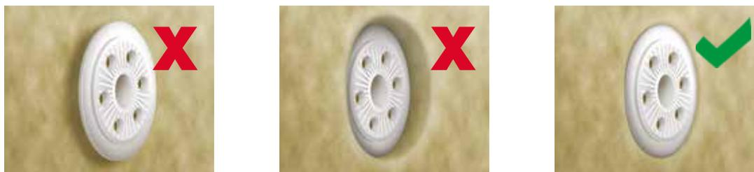
Figura 15 - A sinistra e al centro, errori nel posizionamento dei tasselli di vincolo meccanico dell'isolante; a destra, corretta modalità di posa
