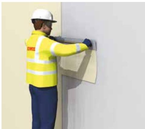
Figura 19 - Applicazione della finitura (tonachino) sulla rasatura armata trattata con fissativo (primer)
