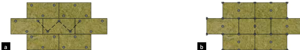
Figura 14 - Rappresentazione grafica dello schema di posa dei tasselli per il fissaggio dei pannelli isolanti al supporto. a) Schema di posa a W; b) Schema di posa a T
