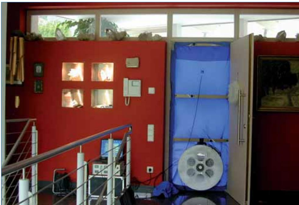
**Figura 2.15** Misura della permeabilità all'aria: visibili la tenuta sulla porta, il ventilatore e gli strumenti di misura e registrazione.
