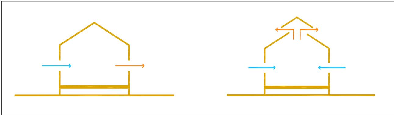
Aperture poste su fronti sopravvento e sottovento in corrispondenza tra loro favoriscono la circolazione dell'aria. Se l'apertura di entrata è più piccola di quella in uscita si verifica "l'effetto Venturi", che massimizza la velocità dell'aria all'interno dell'edificio.
