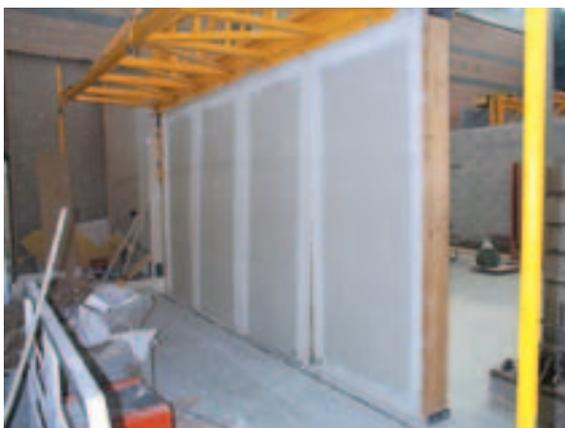
Photographie 2 : vue de la cloison côté opposé au choc après essai
