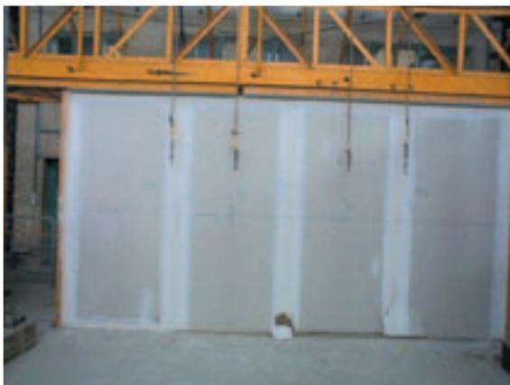
Photographie 1 : vue de la cloison côté choc après essai
