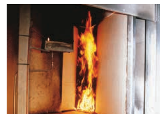
SBI - Ensayo de un contraplacado
