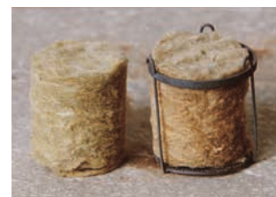
Lana de roca ROCKWOOL, antes y después del ensayo
