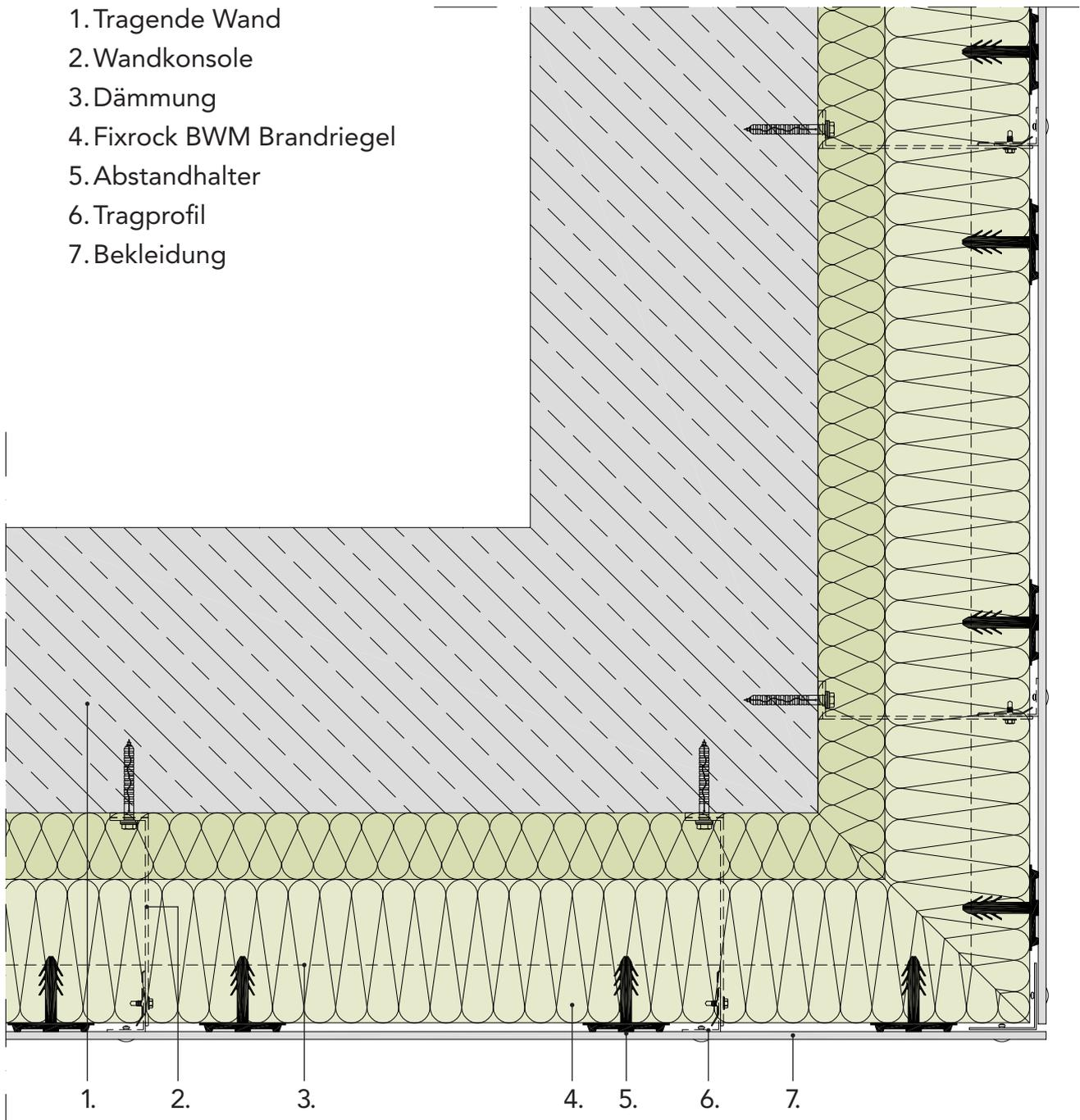
Detail Brandsperre VHF | 01–03 Außenecke
