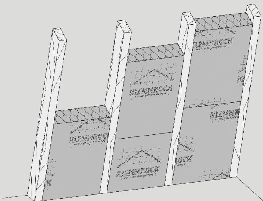
Nichtbrennbare Steinwolle als hoch komprimierte Rolle für die auf Maß geschnittene Dämmung zwischen den Sparren.
