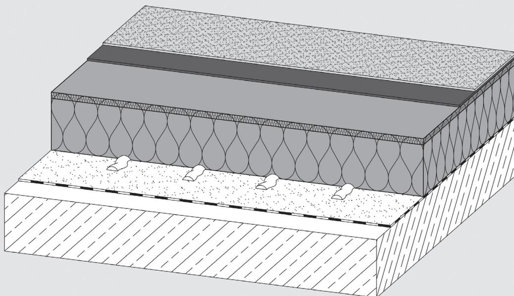
Feuchtigkeitserhärtender, gering expandierender Einkomponenten-Polyurethan-Klebstoff für die Verklebung von druckbelastbaren Mineralwolle-Dämmstoffen.
