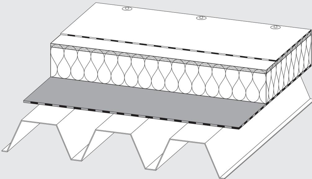
Brandlastarme und kaltselbstklebende Dampf- und Konvektionssperre für Stahlleichtdächer und für Dächer mit Schalung.
