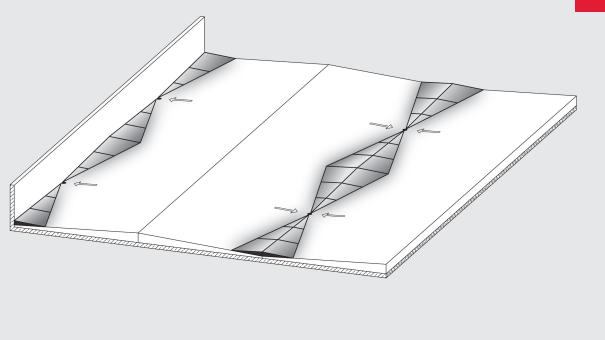
Druckbelastbare, montagefertig zugeschnittene Steinwolle-Kehlgefälleplatte\* mit Standardgefälle in zwei Richtungen.
