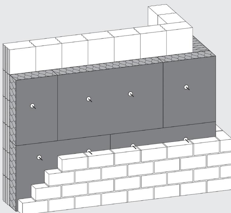
Formstabile Steinwolle-Dämmplatte\* mit einseitiger schwarzer Vlieskaschierung für die Kerndämmung im zweischaligen Mauerwerk. Auch bei einer freien Bewitterung von bis zu 3 Monaten ist die Platte nachgewiesen bewitterungsfest und behält ihre maßgeblichen Eigenschaften.
