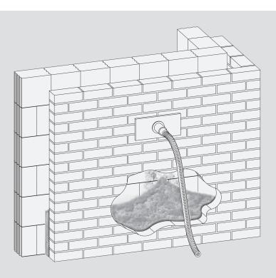
Fillrock KD ist ein flockenförmiges Granulat aus Steinwolle\*, das mittels einer speziellen Maschinentechnik in die Hohlschicht eines zweischaligen Mauerwerks eingeblasen wird.
