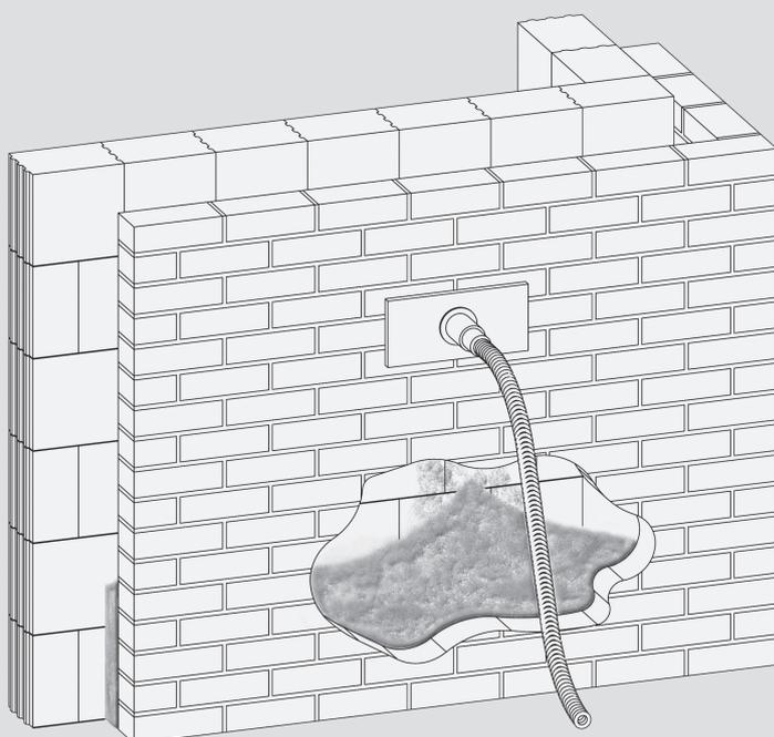
Fillrock KD Plus ist ein flockenförmiges Granulat aus Steinwolle\*, das mittels einer speziellen Maschinenteknik in die Hohlschicht eines zweischaligen Mauerwerks eingeblasen wird.
