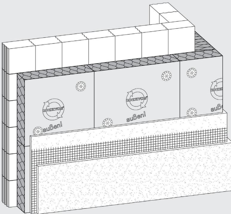
Nichtbrennbare Steinwolle\*-Putzträgerplatte als Kernstück für Wärmedämm-Verbundsysteme. Die Beschichtung auf den Plattenoberflächen ermöglichen die maschinelle Verarbeitung des Klebemörtels auf dem Untergrund sowie den Putzauftrag ohne Presspachtelung.
