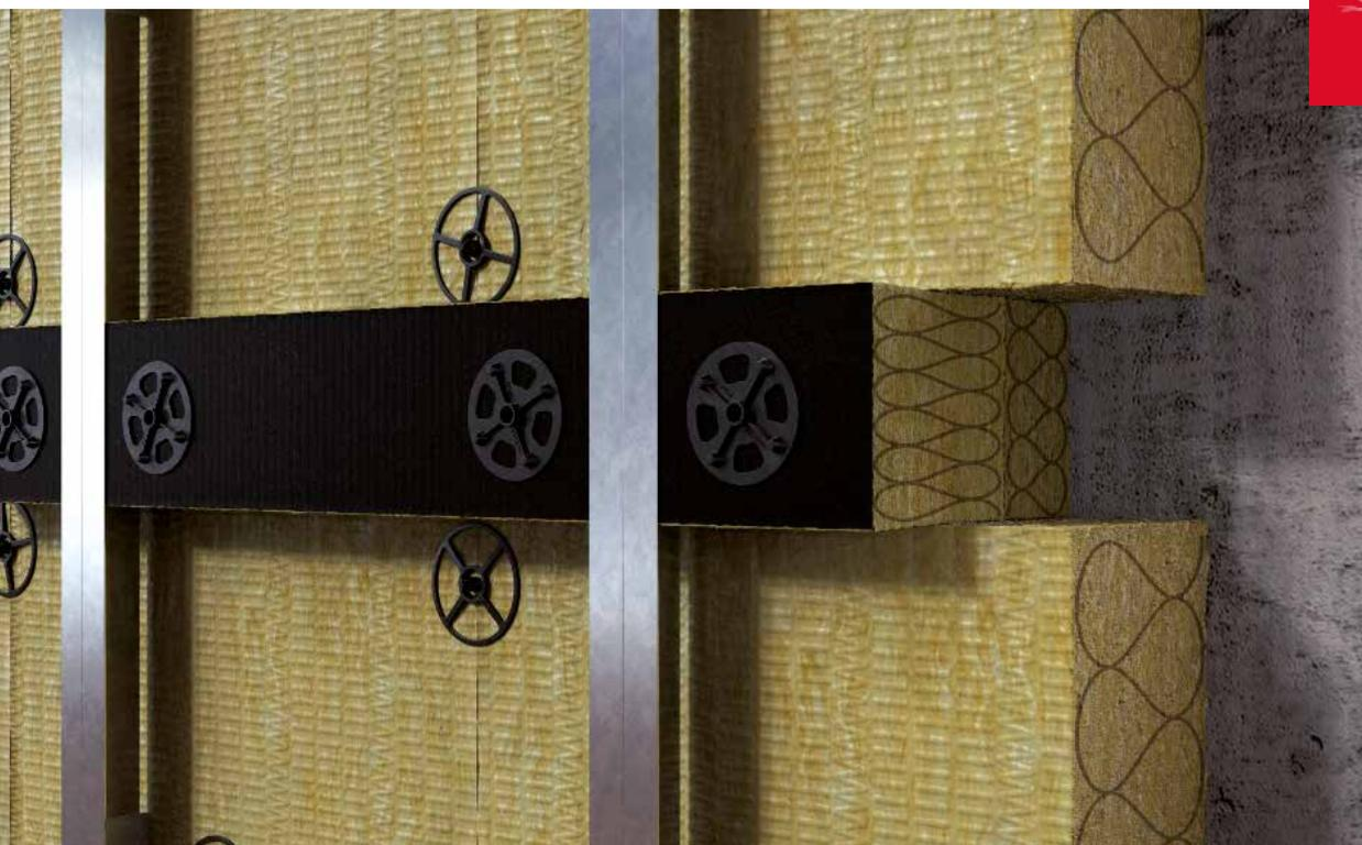
Systemlösung für eine Brandsperre in der vorgehängten hinterlüfteten Fassade bestehend aus einem Steinwolle-Brandriegel in Zweischichtcharakteristik und Abstandhaltern aus glasfaserverstärktem Kunststoff. Das Kit ist sowohl als horizontale als auch vertikale Brandsperre einsetzbar.
