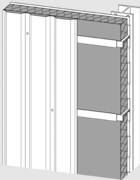
Kunstharzgebundene Steinwolle-Dämmplatte\* mit hoher Wärmedämmwirkung. Sie ist elastisch und passt sich fugenlos der Konstruktion an.
