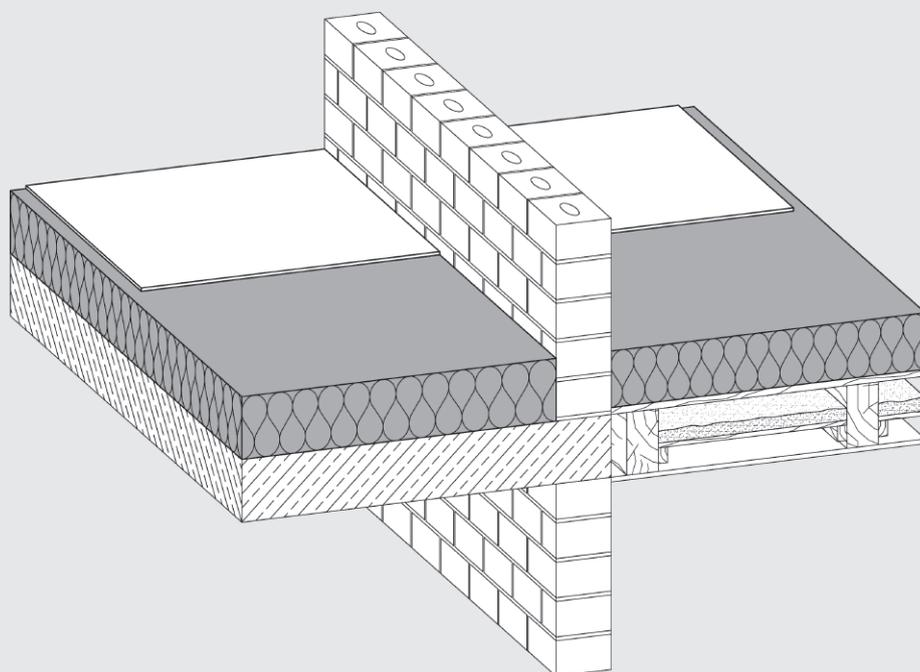
Steinwolle-Dämmplatte für die Wärmedämmung der obersten Geschossdecke für Bereiche mit mittleren Anforderungen an die Druckfestigkeit.
