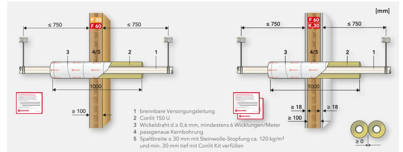
Die Ausführungen in Brettsperrholzwänden entsprechen dem ROCKWOOL abP P-3726/4140-MPA BS i. V. m. der gutachterlichen Stellungnahme GA-2016/059d - Nau.
