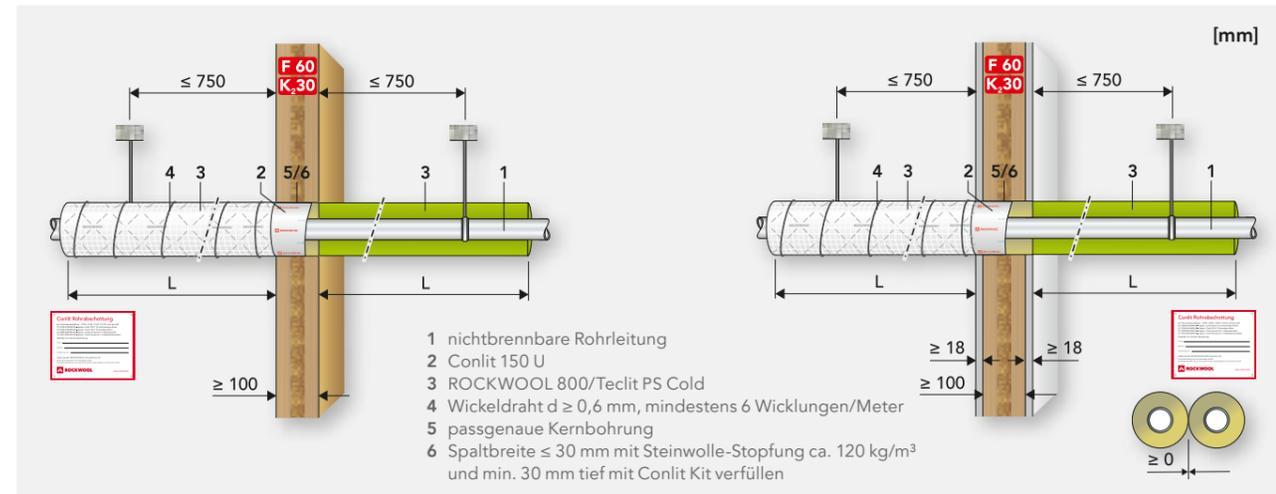
Die Ausführungen in Brettsperrholzwänden entsprechen dem ROCKWOOL abP P-3725/4130-MPA BS i. V. m. der gutachterlichen Stellungnahme GA-2016/059d - Nau.
