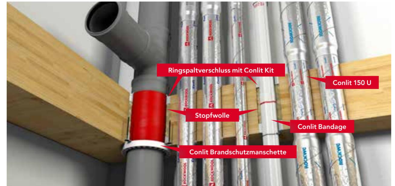
Die Conlit 150 U Schalen werden wie gewohnt zur Ummantelung von Rohrleitungen in passgenaue Kernbohrungen eingesetzt. Die mit der Conlit Bandage umwickelten Kabelbündel sowie die brennbaren Entwässerungsleitungen werden ebenfalls durch Kernbohrungen geführt. Der verbleibende Restspalt wird dabei mit loser Mineralwolle und dem Conlit Brandschutz Kit schnell und einfach verschlossen. Die Conlit Brandschutzmanschette wird wie gewohnt unterhalb der Decke mit Schrauben befestigt.
