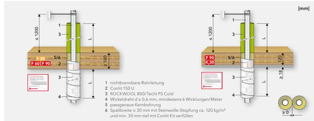
Die Ausführungen in Brettsperrholzdecken entsprechen dem ROCKWOOL abP P-3725/4130-MPA BS, Anlage 31 und 32.
