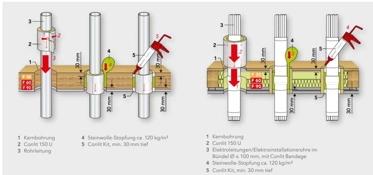
Spaltmaße bis 30 mm können mit Conlit Kit verschlossen werden. Dieser ist in der gesamten Bauteiltiefe einzubringen oder in einer Tiefe von mindestens 30 mm zu beiden Seiten der Bauteiloberflächen, wenn der Restspalt zuvor mit einer Steinwolle-Stopfung ca. 120 kg/m<sup>3</sup> versehen wurde. Grundsätzlich ist auf einen bautiefen und hohlraumfüllenden Spaltverschluss zu achten.
