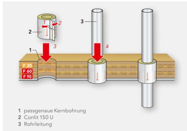
Die Brandschutzschalen Conlit 150 U sind im Außendurchmesser den gängigen Kernbohrungsmaßen angepasst. Für die brandschutztechnischen Abschottungen der Rohrleitungen können diese passgenau in die Bohrung eingeschoben werden. Weitere Maßnahmen zum Bauteilverschluss wie eine Vermörtelung können daher entfallen. Bei entsprechender Planung können somit Zeit und Kosten reduziert werden.
