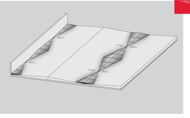
Druckbelastbare, montagefertig zugeschnittene Steinwolle-Kehlgefälleplatte\* mit Standardgefälle in zwei Richtungen.
