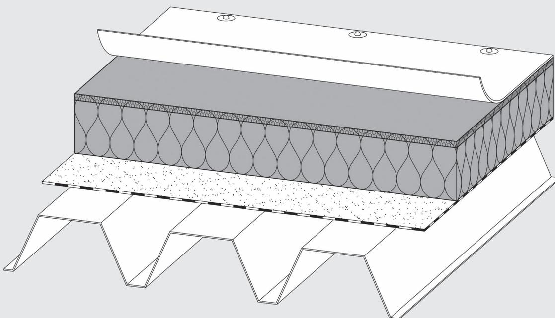
Steinwolle-Dachdämmplatte\* mit erhöhter Punktbelastbarkeit durch integrierte Zweischichtcharakteristik. Aufgrund ihrer hoch verdichteten, lastverteilenden Oberlage bietet sie eine verbesserte Widerstandsfähigkeit gegen mechanische Beanspruchungen.
