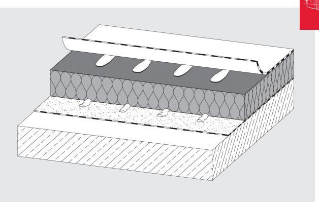
Hoch verdichtete, druckbelastbare Steinwolle-Dachdämmplatte\* mit oberseitiger Mineralvlieskaschierung.
