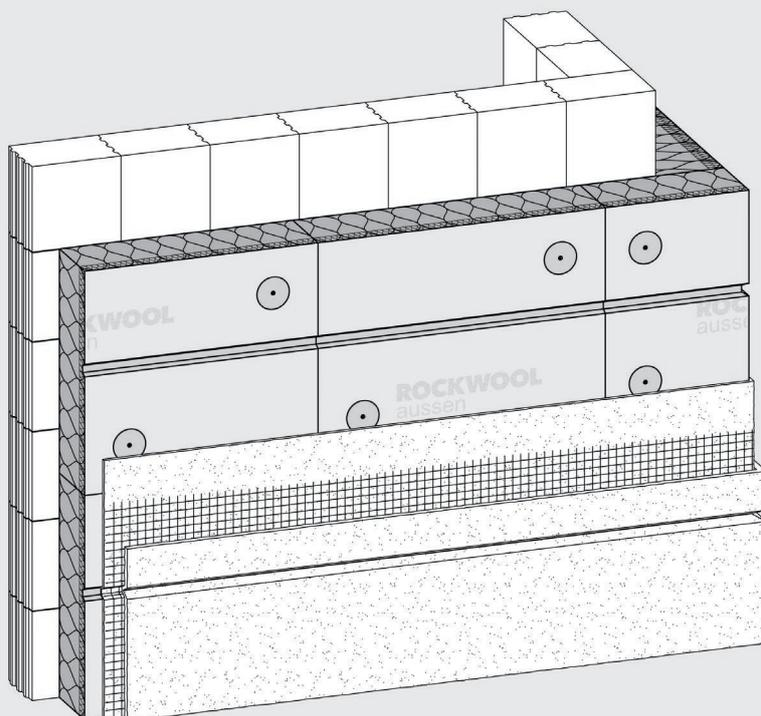
Nichtbrennbare Steinwolle\*-Putzträgerplatte als Kernstück für Wärmedämm-Verbundsysteme. Die Beschichtung auf den Plattenoberflächen ermöglicht die maschinelle Verarbeitung des Klebemörtels auf dem Untergrund sowie den Putzauftrag ohne Pressspachtelung. Eine spezielle Nutenfräsung ermöglicht den direkten Einsatz in WDVS mit Bossenoptik.
