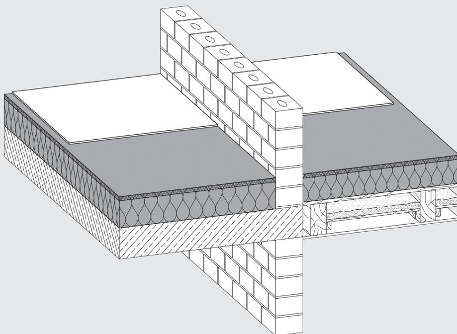
Steinwolle-Dämmplatte\* für die Wärmedämmung der obersten Geschossdecke für Bereiche mit geringen Anforderungen an die Druckfestigkeit.
