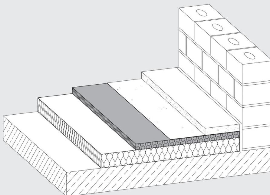
Steinwolle-Dämmplatte\* für die Trittschall-, Luftschall- und Wärmedämmung von Geschossdecken und Böden unter schwimmenden Mörtel- und Fließestrichen.
