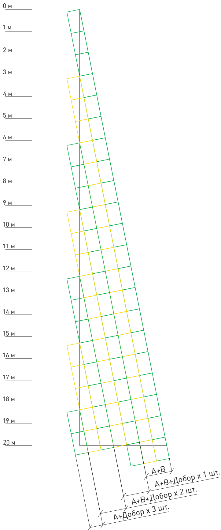
Схема раскладки и крепления элементов набора «Контруклон СТАНДАРТ» 5к1
