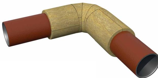
Схема изоляции отводов и тройников малых диаметров
