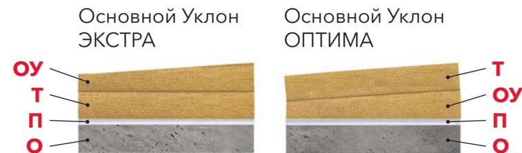
**ОУ** - элемент Основного Уклона
