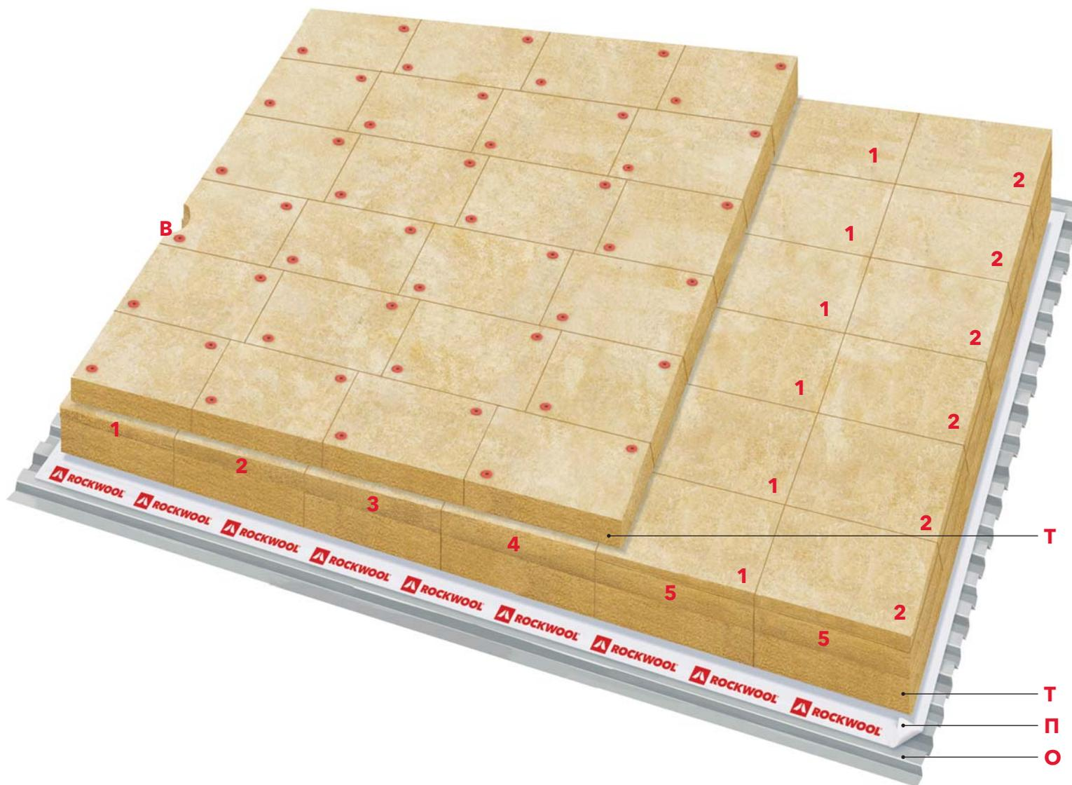
Установка теплоизоляции должна производиться поверх смонтированных элементов последовательно, чтобы исключить перемещение по поверхности элементов уклона.
