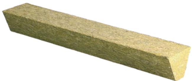
Для заполнения гофр металлического профилированного настила. В том числе при устройстве теплоизоляционного слоя из сгораемых и трудносгораемых материалов заполнение пустот ребер настилов на длину 250 мм в местах примыканий настила к стенам, деформационным швам, стенкам фонарей, а также с каждой стороны конька кровли и ендовы.
