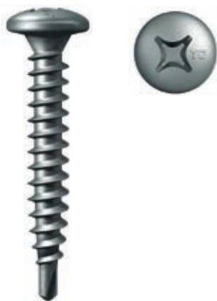
Изделие выполнено из закаленной высококачественной углеродистой стали марки С 1022 со стойким антикоррозийным покрытием Dacromet, протестированным в камере Kesternich в атмосфере конденсата водяного пара с содержанием диоксида серы (SO<sub>2</sub>) в соответствии со стандартом DIN 50018.
