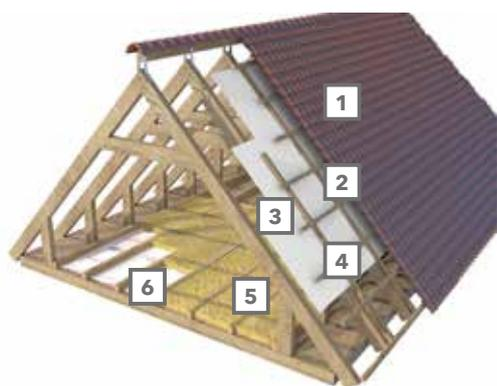
Конструкция неутепленной скатной кровли
