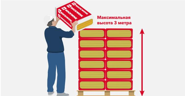
2.2. Максимальная высота штабеля пачек: 5 м, для продукции с номинальной плотностью 100 кг/м<sup>3</sup> и более; 4 м – для продукции с плотностью от 40 до 99 кг/м<sup>3</sup>; 2,5 м – для продукции плотностью менее 40 кг/м<sup>3</sup>. Продукты двойной плотности оцениваются по слою с наименьшей плотностью.
