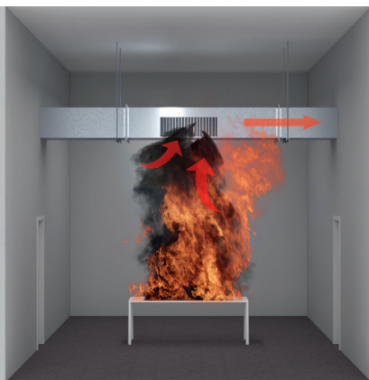
Brandbelastning ved kanalåbning
