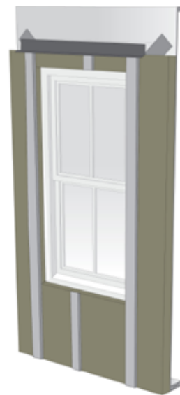
Étape 15: La patte extérieure du contre-solin est prolongée au-delà de la face du couvre-joint (qui sera ajouté à l'Étape 19).
