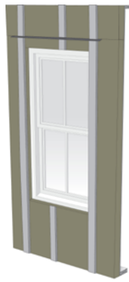
Étape 15: La patte extérieure du contre-solin est prolongée au-delà de la face du couvre-joint (qui sera ajouté à l'Étape 19).
