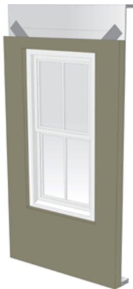
Étape 13: Poser l'isolant ROCKWOOL COMFORTBOARD™ 80.
