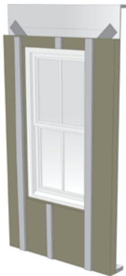
Étape 14: Poser les fourrures par-dessus l'isolant ROCKWOOL COMFORTBOARD™ 80.
