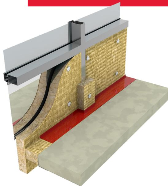
Curtainrock<sup>MD</sup> de ROCKWOOL est un panneau isolant de laine de roche, semi-rigide conçu expressément pour répondre aux diverses spécifications de murs-rideaux
