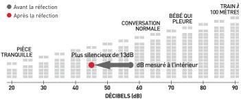
« Partant des mêmes niveaux sonores du toit calculés avant et après la réfection, le niveau CRB intérieur a été réduit de 61 CRB à 39 CRB, et le niveau sonore intérieur a baissé de 58 dBA à 45 dBA. Cette réduction résulte directement de la réfection de la toiture avec l'ajout de l'isolant ROXUL TOPROCK DD de 2,5 po. »
