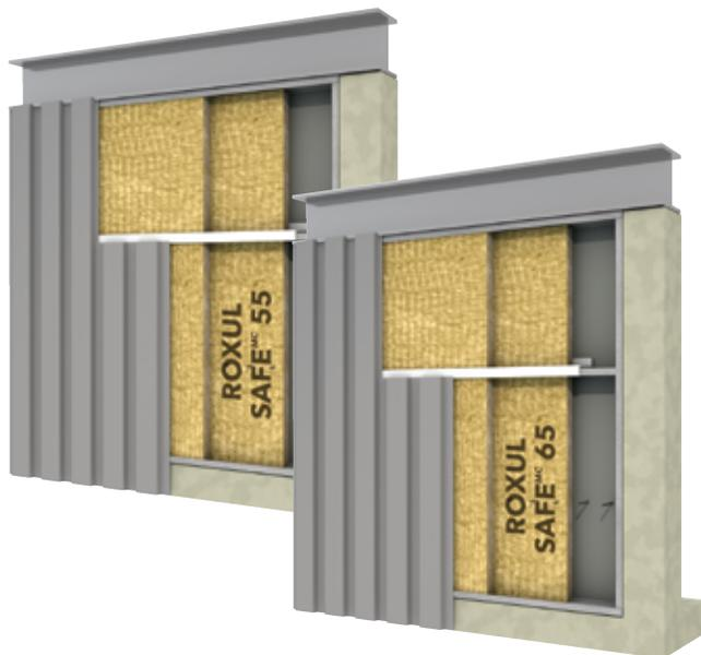
Composition : bardage métallique extérieur, ROXUL SAFE<sup>MC</sup> 55 & 65, barres en Z, couverture en céramique anti-feu pour Z, solins, revêtements et accessoires pour murs et cloisons
