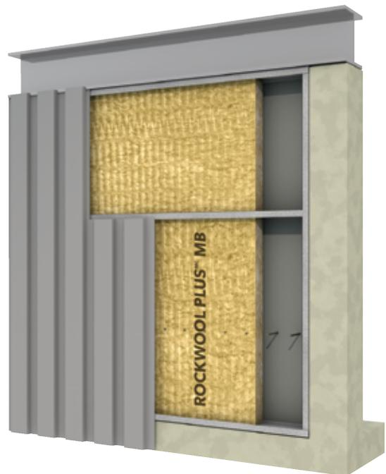
Composantes : bardage métallique extérieur, ROCKWOOL PLUS<sup>MC</sup> MB, barres en Z, solins, revêtements et accessoires pour murs et cloisons
