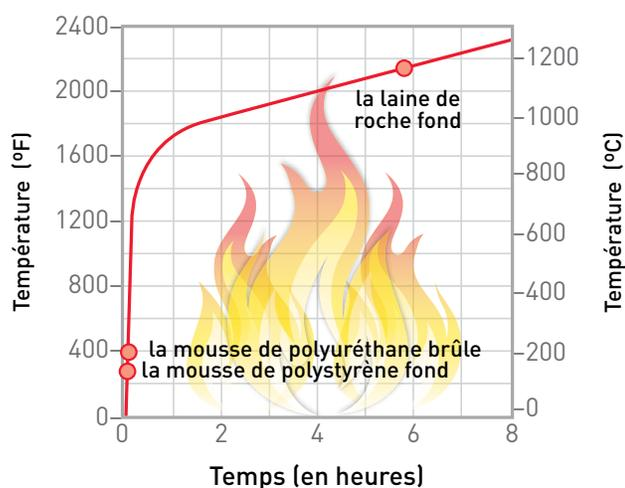
Là où des températures élevées constituent un problème, la laine de roche offre une plus grande protection que la fibre de verre. La température de service maximale de l'isolant de laine de roche a été mise à l'essai selon la norme ASTM C 411, à 650°C (1 200°F), par comparaison à la fibre de verre dont la température de service maximale est limitée à 232°C (450°F).
