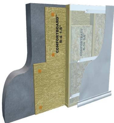
L'isolant ROCKWOOL a été inclus dans le meilleur mur de sous-sol, et éventuellement le mur de sous-sol optimal, en raison de sa performance et de sa capacité à régler les problèmes d'affaissement, de pont thermique et de formation de moisissure dans le mur.
