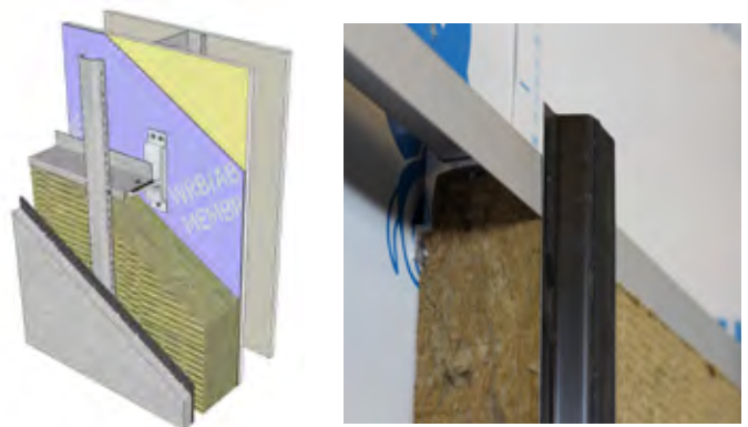
Clip de aluminio en T con perfiles horizontales en Z y perfiles omega verticales para sujetar el revestimiento.
