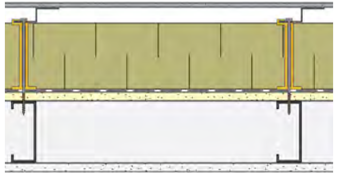
Muro de postes de acero de 3 5/8" no aislado con aislante exterior y sistema de sujeción del revestimiento.
