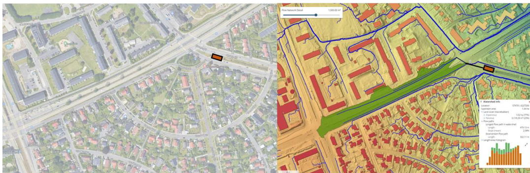
Figur 1.1. Oversigt over område, opland (grønt fremhævet t.h. fra SCALGO Live) og placering af Rockflow (sort omridset rektangel)
